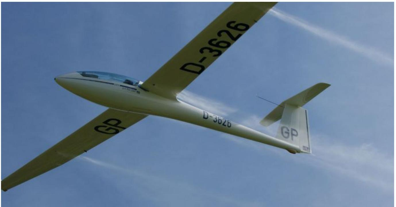
— Überflug der LS 8 D-3626 beim Ablassen des Ballastwassers
