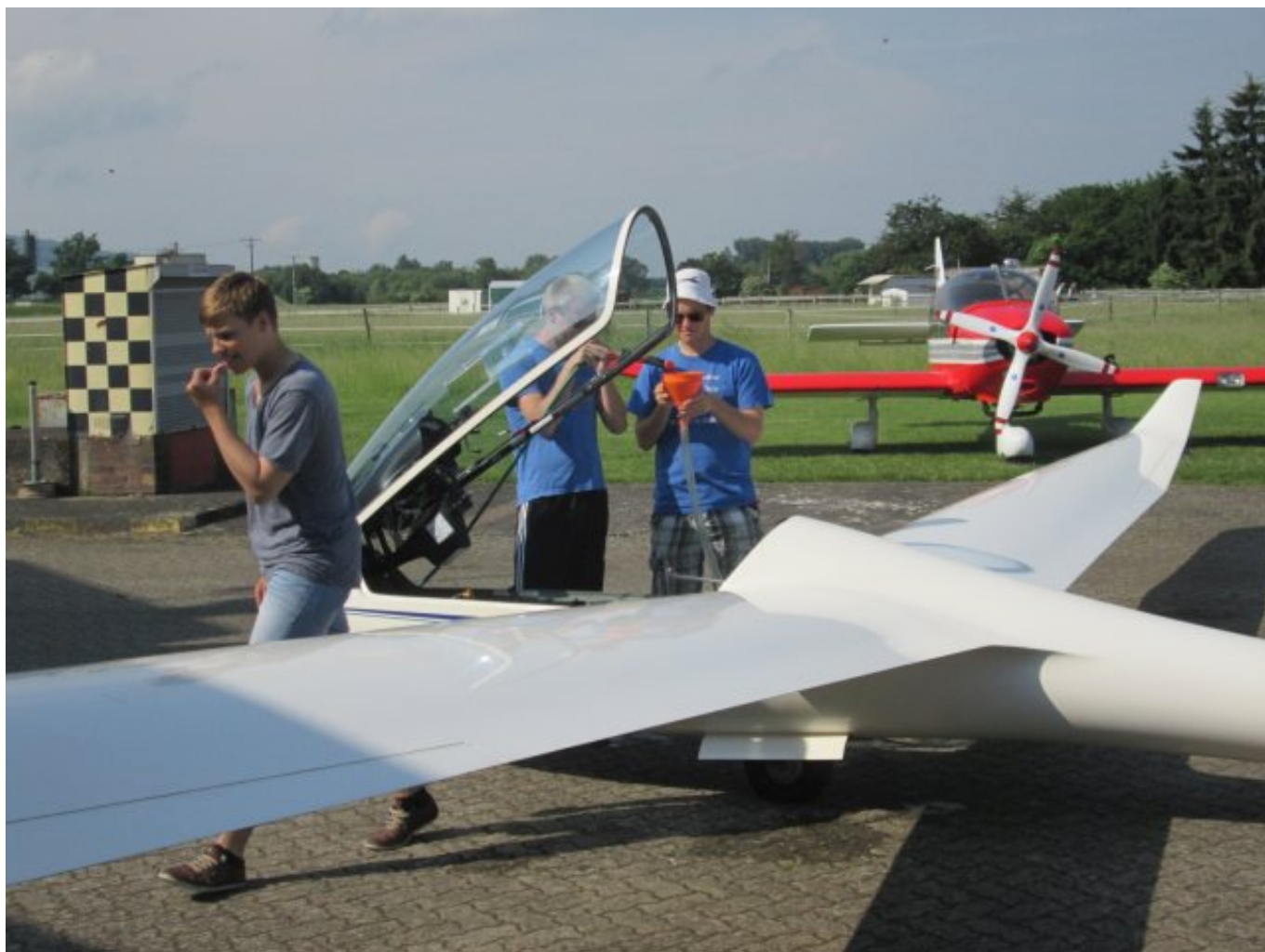
Dominik Biesenecker (rechts) und Philipp Lauer (links) beim Befüllen der Vereins LS 8 mit Wasserballast für schnelle Flüge in der Bundesliga
